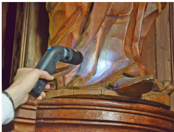
Obr. 80 Kontrola plesní pomocou UV lampy
