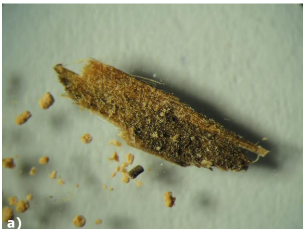
Obr. 51 a – b) Fotograficky zdokumentované požerky pomocou optickej mikroskopie, rok 2016-2017
