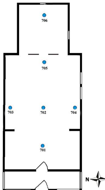
Obr. 11 Pôdorys grécko-katolíckeho Chrámu sv. Mikuláša v obci Bodružal s vyznačením miest meraní relatívnej vzdušnej vlhkosti v interiéri
