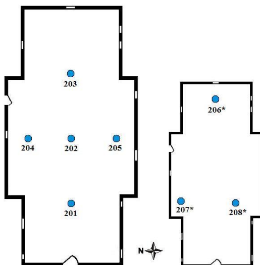
Obr. 64 Pôdorys artikulárneho evanjelického kostola v Leštinách s vyznačením miest meraní relatívnej vzdušnej vlhkosti v interiéri
