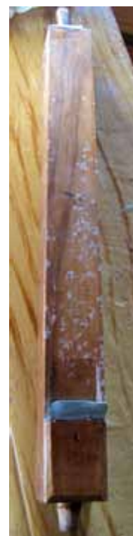
Poškodenie drevokazným hmyzom
