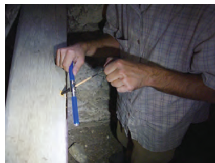
^ Presslerov prírastkový nebožiec pri odobraní vzorky (vysunutá vzorka letokruhového radu) z väzného trámu krovu (Tomáš Kyncl). Foto: Ľ. Suchý, 2002.
