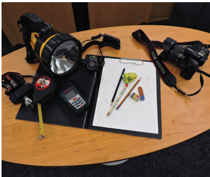
Pracovné predmety pre prácu v podstreší (baterka, pásno, dosky, ceruzka, čelov- ka, fotoaparát). Foto: Ľ. Suchý, 2018. >
