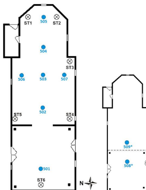
Obr. 16 Pôdorys rímskokatolíckeho Kostola sv. Františka z Assisi s vyznačením jednotlivých miest meraní v interiéri. (⊗miesto merania vlhkosti drevnej hmoty, ● miesto merania relatívnej vzdušnej vlhkosti).
