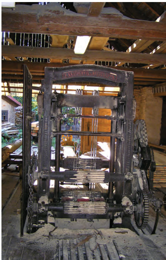
Cerekvice nad Loučnou čp. 24, okres Svitavy. Nejvíce rozšířeným doplňkovým provozem u českých mlynů se staly pily. Pohled do pilnice s vícelístovou pilou v litinovém rámu. Foto: Radim Urbánek, 2004.
