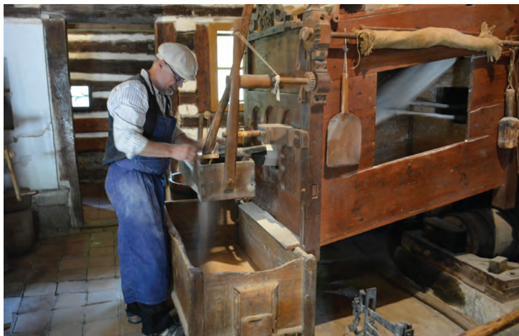
Veselý Kopec, okres Chrudim. Zprovoznění obyčejného složení transferovaného v 70. letech z Oldřetic, okres Chrudim. Pod žejbrem je vidět „proud“ vysévané krupice. Foto: Jan Doubek, 2022.
