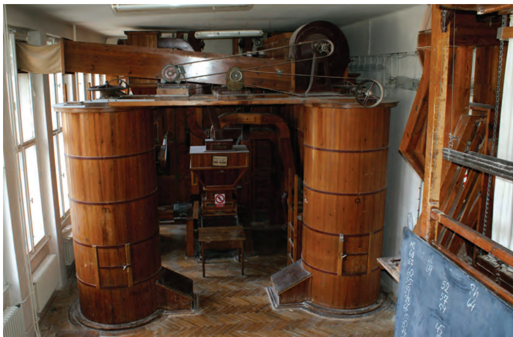
Pardubice čp. 116, okres Pardubice. Pohled do interiéru mlýnice školního mlýna. Ve funkční podobě reprezentuje umělecké mlecí složení odpovídající středně velkému venkovskému mlýnu. Foto: Radim Urbánek, 2010.
