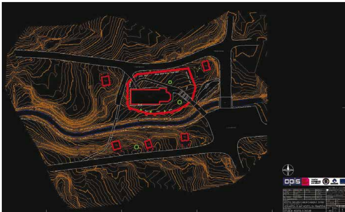
5. Hervartov, Kostol sv. Františka z Assisi s okolím, situácia objektu s vrstevnicami, technická výkresová dokumentácia. Vyhotoval P. Brunčák. Zdroj: Oddelenie digitalizácie a grafickej dokumentácie PÚ SR.
