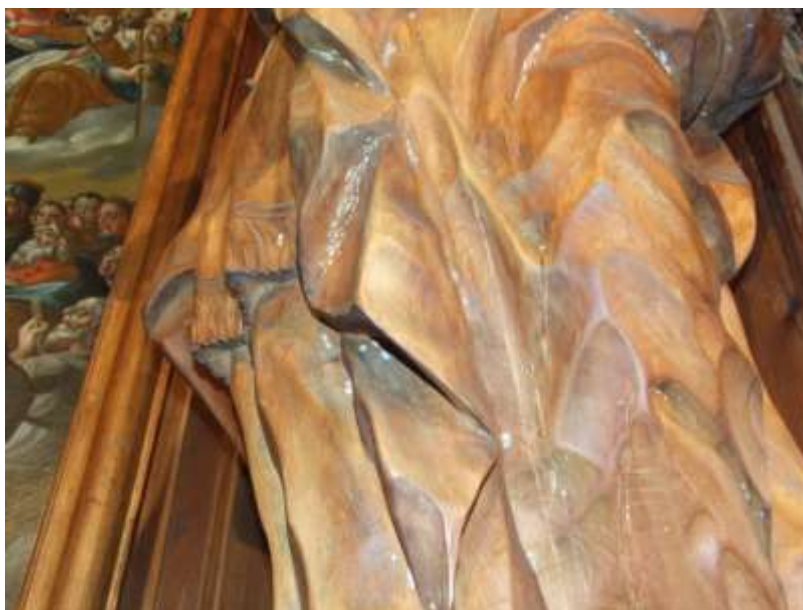
Obr. 8.4. Napadnutie drevených sôch oltára plesňami; plesne sa koncentrujú najmä v hlbších záhyboch
