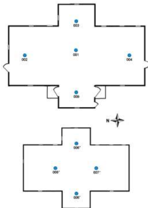
Obr. 3.5. Pôdorys artikulórného evanjelického kostola s vyznačením miest meraní relatívnej vzdušnej vlhkosti v interiéri
