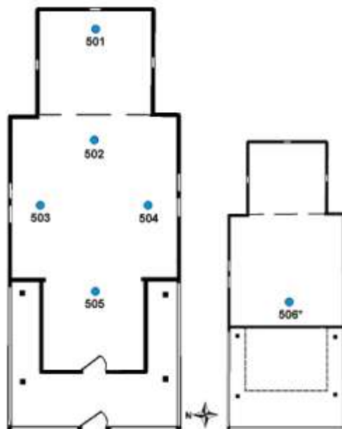
Obr. 5.4. Pôdorys grécko-katolíckeho chrámu sv. Michala archanjela v Ladomirovej s vyznačením miest meraní relatívnej vzdušnej vlhkosti v interiéri.
