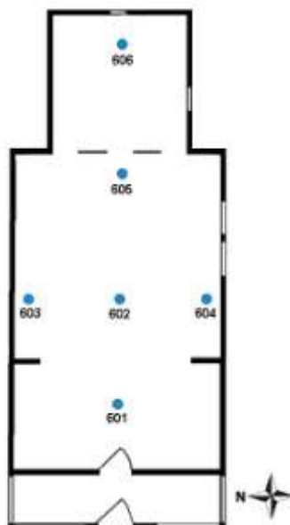
Obr. 1.3. Pôdorys grécko-katolíckeho chrámu sv. Mikuláša v obci Bodružal s vyznačením miest meraní relatívnej vzdušnej vlhkosti v interiéri.
