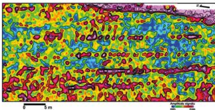
301. Výsledky georadarových meraní na vojnovom cintoríne v meste Humenné – horizontálne georadarové rezy pre hĺbky od 17 do 48 cm (2022) (Zdroj: TIRPÁK, Humenné, 2022, c.d., s. 6.)
