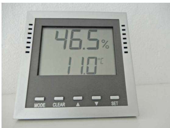
► Obr. 42. Výsledok sanácie depozitára Pamiatkového úradu SR v Trnave je priebežne monitorovaný v interiéri objektu. Dosažená vlhkosť vzduchu je vyhovujúco nízka.
