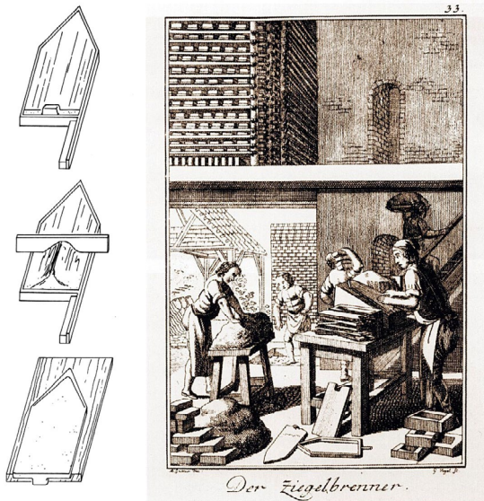
► Obr. 7a, 7b. Postup ručnej výroby škridly do drevenej formy.
