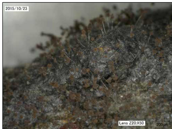
Obr. 11. Čierna pleseň na náleze po aplikácii kontaminovaného tanátovacieho roztoku.
