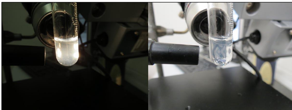
Obr. 6. Stanovenie chloridov vo vzorke pri správnom osvetlení.
