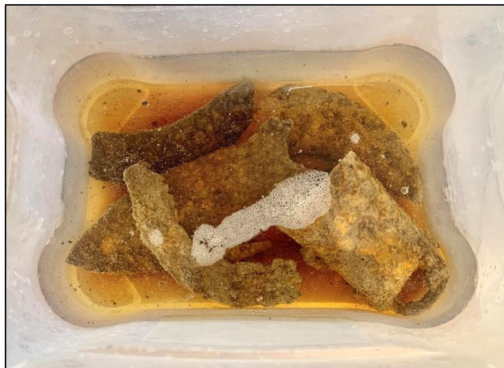
Obr. 5. Druhotná korózia na desalinovaných nálezoch v destilovanej vode.
