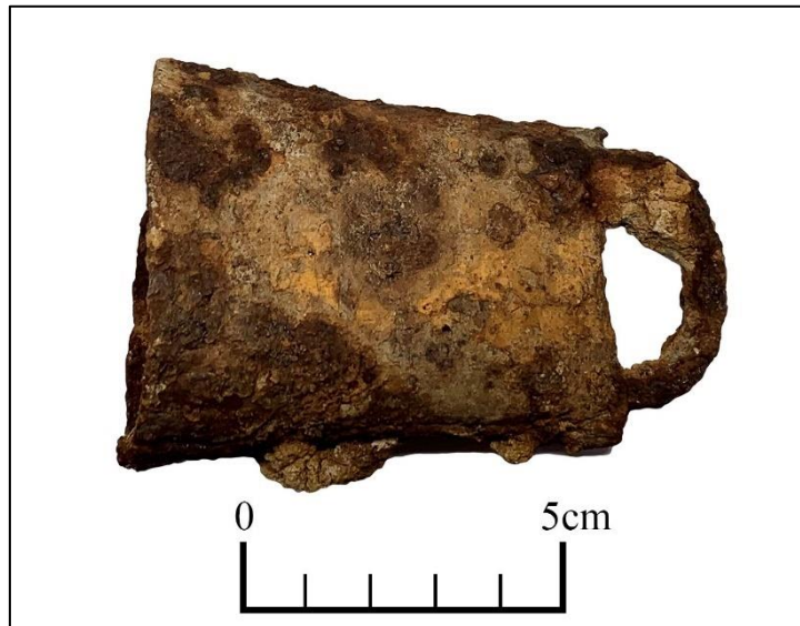
Obr. 1. Chloridová korózia na povrchu archeologického nálezu.
