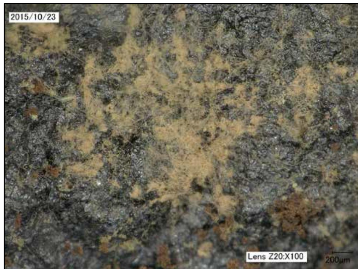
Obr. 10. Biela pleseň na náleze po aplikácii kontaminovaného tanátovacieho roztoku.
