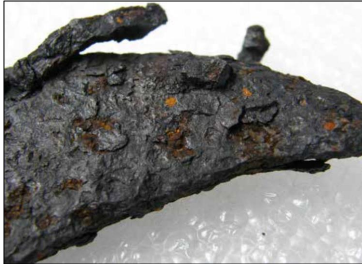
Obr. 14. Aplikácia tanátovacieho roztoku na nález bez predchádzajúcej stabilizácie.
