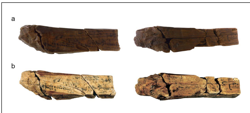
Obr. 9. Vlhké drevo pred (a) a po ošetrení prípravkom PEG (b).
